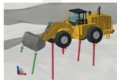
Simulation eines Radladers: Visualisierung der Kräfte auf Räder und Schaufel in SimulationX
